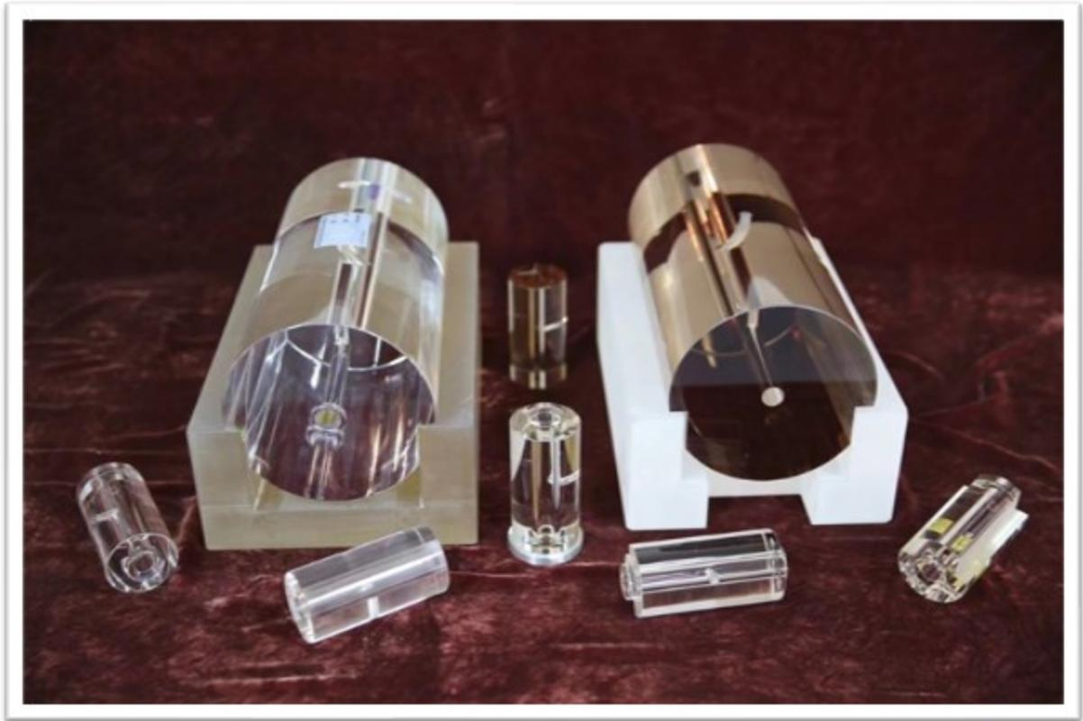
我公司提供的光学超稳腔腔体所有表面及通光孔、通气孔全抛光、便于腔体的光路孔及表面的清洁有利于系统的真空度提高与保持。相比其他单位和部分进口腔体表面化学腐蚀抛光，材料加工过程中产生的表面应力去除彻底，稳频性能更好。
